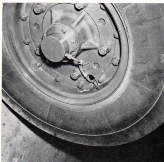
Le distributeur permet le gonflage et le dégonflage simultané de toutes les roues.
