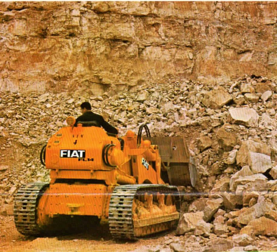
*La puissance du FL14 permet d'avoir un cycle de travail continu avec une production horaire élevée même dans les conditions d'extraction les plus difficiles. Grâce à son robuste moteur de 6 cylindres fournissant 150 ch au volant **sans** turbochargeur, grâce à ses 15.400 kg et à un godet de 1,72 m<sup>3</sup>, le FL14 est le chargeur le plus adapté aux chantiers de haute productivité avec chargement en continu*
